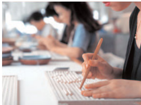
同じ等級の粒を並べてネックレスに仕上げる作業
