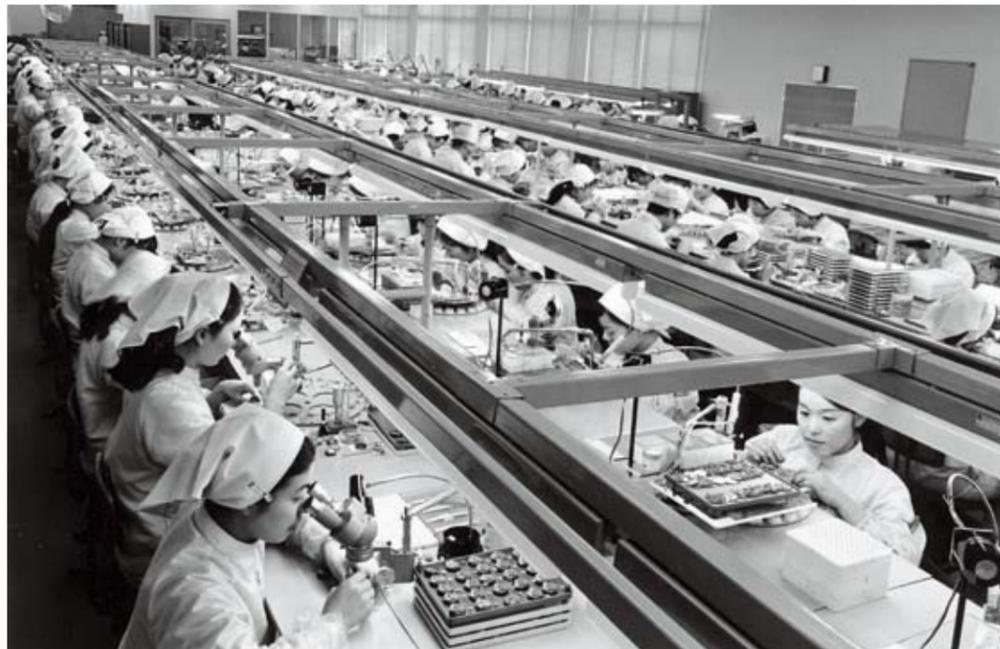
Ligne d'assemblage des montres-bracelets dans une usine Seiko aux environs de 1970. Le nombre de pièces produites augmenta exponentiellement au Japon entre 1960 et 1970, grâce à une qualité strictement contrôlée et un système de production de masse en place dans l'industrie après le milieu des années 50.
