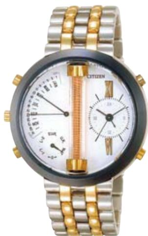
La première montre au monde capable d'ajuster son heure grâce aux signaux émis par diverses stations émettrices. Produite en 1993 par Citizen, sa précision était assurée grâce aux signaux de fréquence reçus du Japon, d'Allemagne et d'Angleterre. L'antenne de réception est logée au milieu du cadran.
