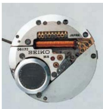
À droite : La première montre à quartz du monde fut la Quartz Astron, produite par Seiko en 1969. Les consommateurs furent séduits par une précision de 0,2 seconde par jour, ou 5 secondes par mois. À gauche : Les entrailles d'une Quartz Astron.
