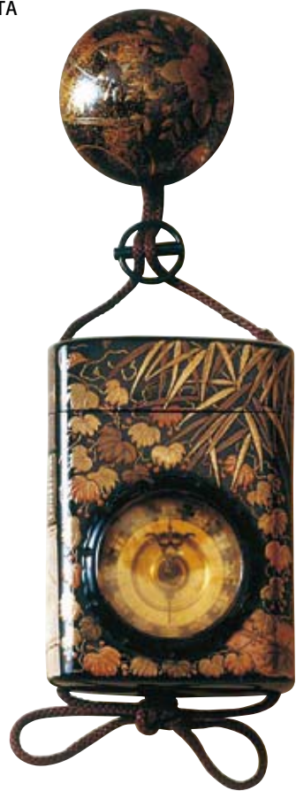
上：以精工“ASTRON”冠名的型号。它具有利用GPS卫星自动修正时间的功能，因此，从珠穆朗玛峰山顶到南极，在世界任何地方都能获得准确的时间。 右：安在用于携带药品等的小盒（印笼）上的“印笼钟”，通过使字盘上数字的移动来应对不同季节昼夜的不同长短。“印笼钟”使用龟甲或泥金画以豪华装饰。
