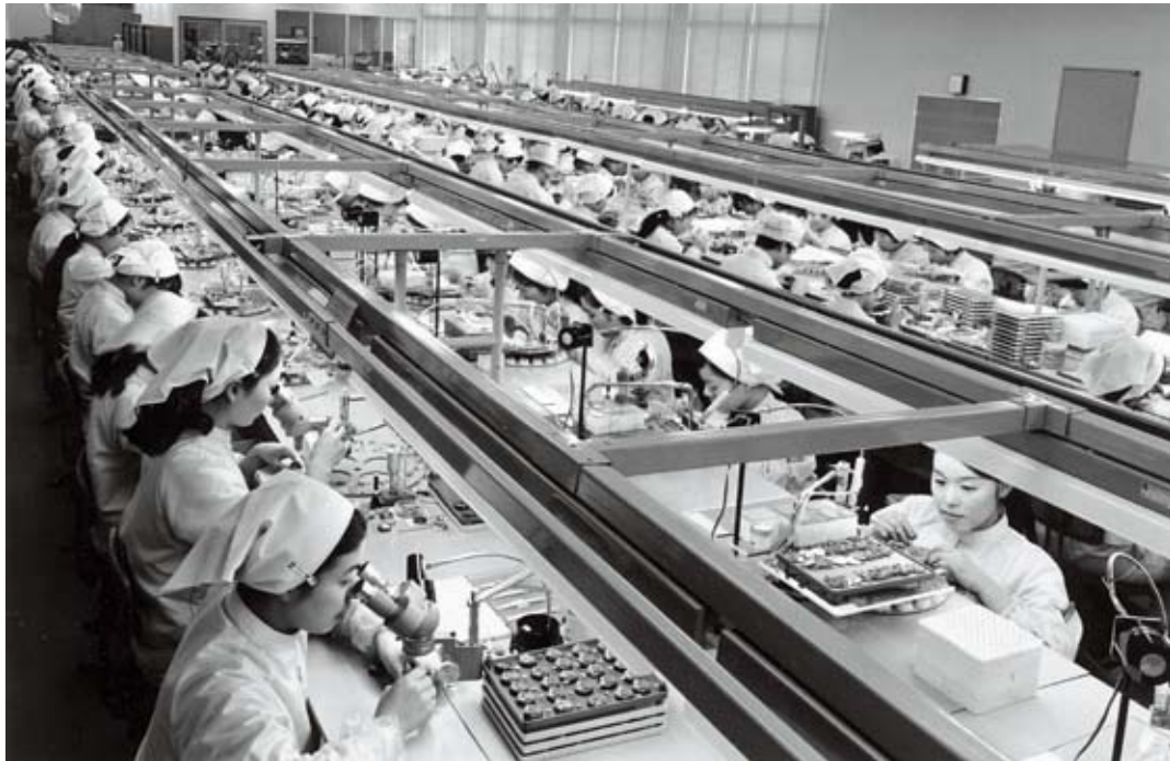
机械式手表的组装流水线 (1970年左右, 精工)。日本的钟表产业在二十世纪五十年代后半期完善了品质管理及批量生产体制, 其结果, 使六十至七十年代的生产数量显著上升。
