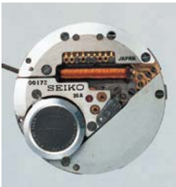
右:世界首款石英表“QUARTZ ASTRON”(1969年, 精工), 一天的误差在0.2秒, 一个月的误差也仅5秒, 准确性之高令人惊叹。 左:“ASTRON”的动力机械部分。
