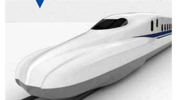
La forme de l'avant du N700S a évolué afin de réduire le bruit et les oscillations, pour un meilleur confort à bord.
